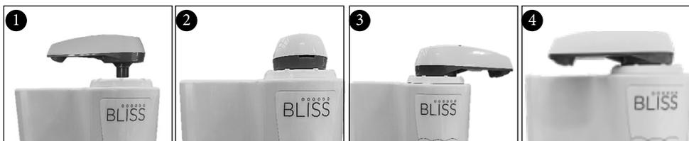
Com leve pressão, encaixe a bica na tampa superior do gabinete com a saída de água voltada para trás (2). Após o encaixe, gire-a para a frente no sentido horário (3 – 4). Esta operação deve ser realizada antes de fixar o purificador na parede.
